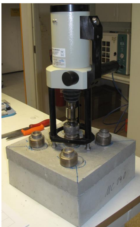
FIGUR 4: FÖRSÖKSUPPSTÄLLNING FÖR UTDRAGSPROV
